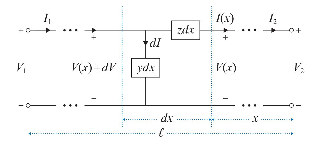
$$\begin{bmatrix} V(x) \\ I(x) \end{bmatrix} = U \begin{bmatrix} e^{\gamma x} & 0 \\ 0 & e^{-\gamma x} \end{bmatrix} U^{-1} \begin{bmatrix} V_2 \\ I_2 \end{bmatrix}$$
